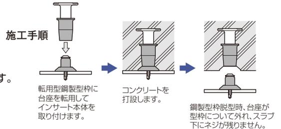
転用型鋼製型枠に台座を転用してインサート本体を取り付けます。
