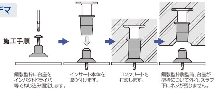
鋼製型枠に台座をインパクトドライバー等でねじ込み固定します。
