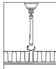
③断熱材を穴あけ後は回転させながら上に引き抜いてください。
