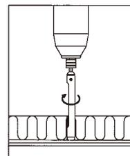
②断熱材に垂直に押し当て、回転させながら穴をあけてください。
