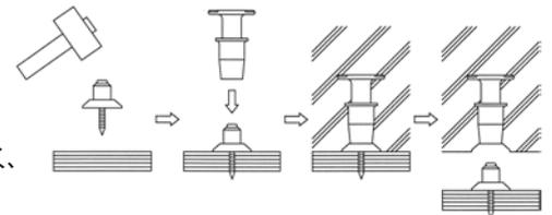
①型枠に台座を打ち込み、インサート本体を取付けます。
