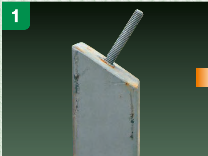
1 手摺子の芯材に30角パイプを採用。角パイプの天端は、笠木の芯材を取付ける為にボルトを溶接しました。
