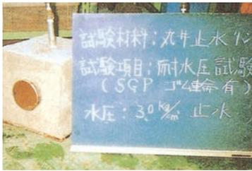
鉄管(SGP)水圧3kgf/cm<sup>2</sup>(0.3MPa)
