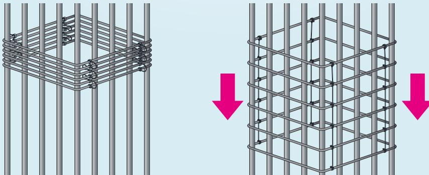
フープ筋に取付け、フープ筋を束ねた状態から精度良く配筋することができます。
