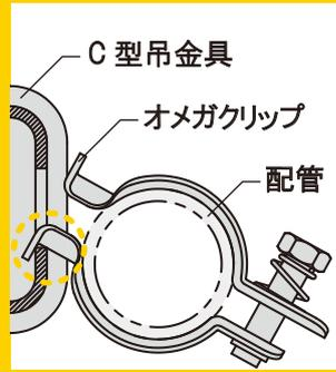
配管にクリップを取付けて、
